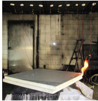
Polyuretaanilevy juuri sytyttämisen jälkeen. Palovaroittimet näkyvät taustalla katossa.
