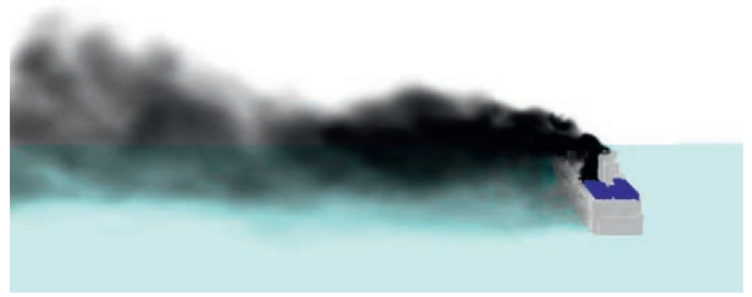
Kuva 7. Savupatsas laivan ulkopuolella 10 minuuttia palon syttymisen jälkeen tapauksessa 12, jossa palo sijaitsee molemmista päädyistä avoimessa ro-ro-tilassa, ja palon aikana vallitsee tuuli tyyrpuurin puolelta.
