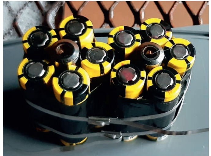
Kuva 2. Testiasetelma ilman muovikoteloa. Sylinterien keskellä näkyvät juotoskynien päät.
