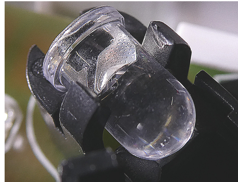
■ Kuva 15. LED normaaleissa käyttöolosuhteissa olleessa palovaroittimessa testijakson päätyttyä. Ylempää kuvaa vastaava varoitin mutta testattu ilman testikaasuja.
