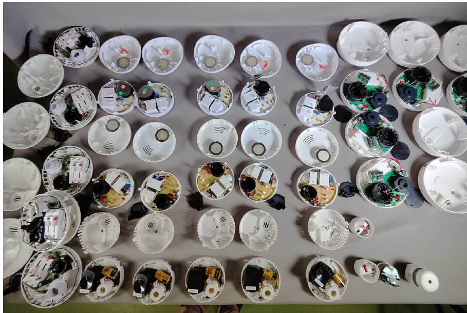
■ Kuva 11. Testatut palovaroittimet avattuna silmämääräistä tarkastelua varten.
