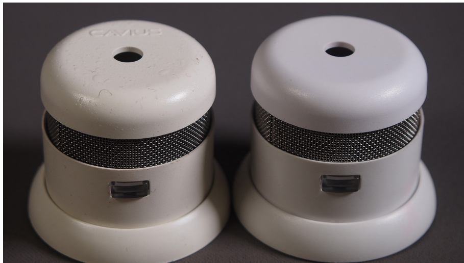
■ Kuva 9. Oikealla normaalissa huonetilassa ollut ns. vertailupalovaroitin ja vasemmalla testikaasuille altistettu palovaroitin.
