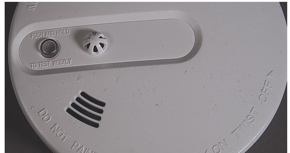
■ Kuva 10. Kolme varoitinta testijakson loputtua. Kuukausitestit tehty kaasulla. Palovaroittimien pinnalla näkyy likaa ja pölyä sekä tahmaisuutta ja testikaasun tiivistymistä.
